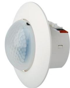
La gama de nuevos sensores UP258 disponen a nivel generales: control de luminosidad integrado, están diseñados para montaje en techo, con acoplador de bus integrado, 3 salidas de control independientes con 4 comandos diferentes por cada salida para diferentes aplicaciones, determinación automática de la luminosidad artificial en la habitación, botón de programación accesible cuando está instalado, pueden ser operados a través de un mando IR y pueden programarse con ETS o Desigo TRA.
