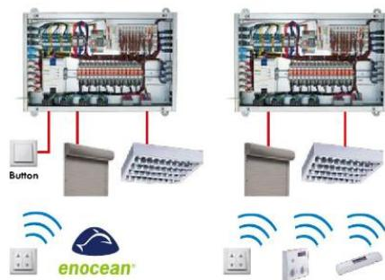
El protocolo ENOCEAN utiliza como fuente de energía adicional pequeños paneles solares, que permiten transmitir las señales sin necesidad de baterías o como en el caso de los pulsadores de 2 o 4 canales, mediante la propia acción mecánica de la pulsación por parte del usuario.
