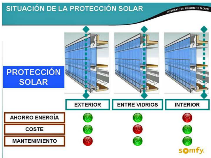
Figura 5: Situación de la Protección solar en la fachada.
