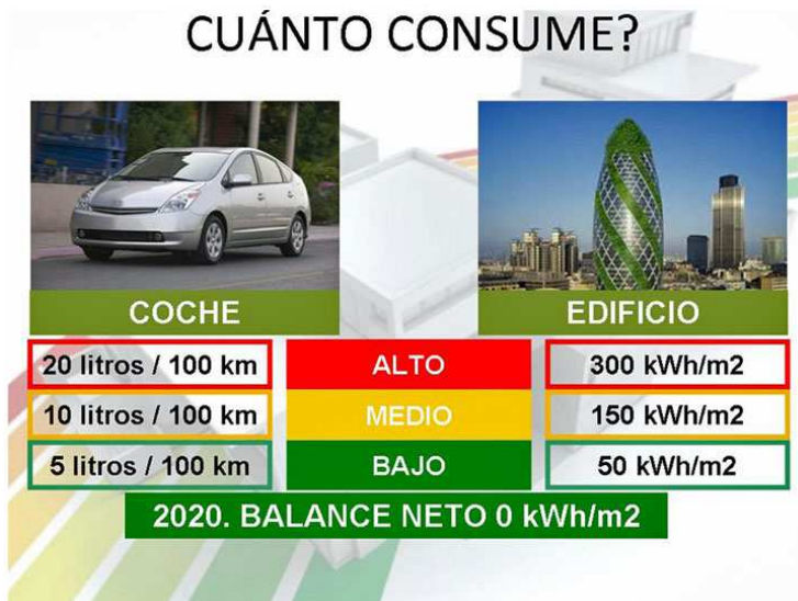
Figura 2. Consumos de un coche y de un edificio.
