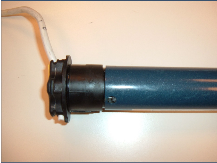
Final de carrera roto
