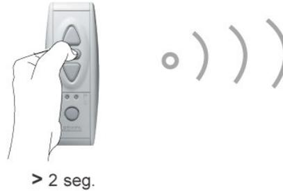
El toldo se mueve brevemente (arriba/abajo) indicando que los puntos alto y bajo han sido memorizados en el operador y que el operador está **en modo instalador**.
