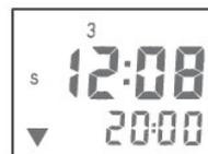
**Nota:** Durante la programación para anular la función de subida y/o bajada pulsar
