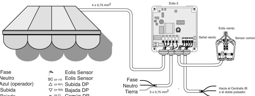
**ADVERTENCIA:** si el toldo desciende cuando se aprieta la tecla de SUBIDA del centralis IB o del doble pulsador, invertir los cables marrón y negro del operador.
