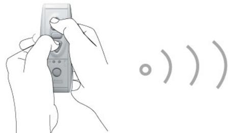
El toldo se mueve brevemente (arriba/abajo) indicando que este emisor controlará el operador durante el modo de fábrica, el operador OREA RTS funcionará únicamente cuando las teclas de subida o bajada estén pulsadas, es decir, en pulsación momentánea.
