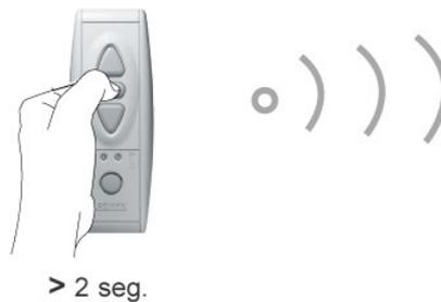
El toldo se mueve brevemente (arriba/abajo) indicando que los puntos alto y bajo han sido memorizados en el operador y que el operador está **en modo fábrica**.
