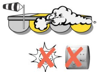
Cuando la velocidad del viento baja del nivel programado, el LED rojo empieza a parpadear. La función SOL permanecerá deshabilitada durante 12 minutos, pero después de 30 segundos, se pueden enviar órdenes manuales.
