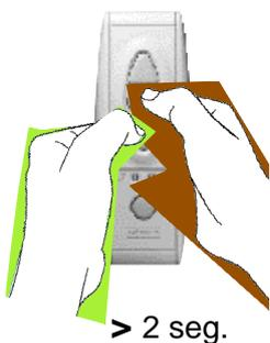
Una vez ajustado el punto alto deseado, pulsar simultáneamente las teclas de bajada y stop durante más de 2 segundos.
