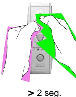
Una vez ajustado el punto bajo deseado, pulsar simultáneamente las teclas de subida y stop durante más de 2 segundos.
