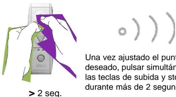
Una vez ajustado el punto bajo deseado, pulsar simultáneamente las teclas de subida y stop durante más de 2 segundos.
