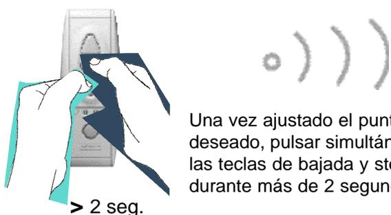
Una vez ajustado el punto alto deseado, pulsar simultáneamente las teclas de bajada y stop durante más de 2 segundos.
