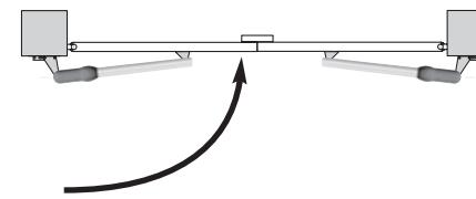
(F) La mémorisation de la course se fait à distance normale, il faut donc éloigner l'émetteur de la cible. Celle-ci commence à la 1<sup>ère</sup> ouverture du portail et se termine à la 2<sup>ème</sup> fermeture (= 2 cycles complets ouverture / fermeture).
