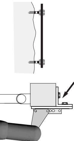
F Les piliers présentant un faux aplomb nécessitent l'utilisation d'une platine spéciale. De même, quand l'un des trous de fixation des pattes pilier est dans le vide ou proche de l'angle du mur, il est impératif de positionner la platine support SOMFY.
