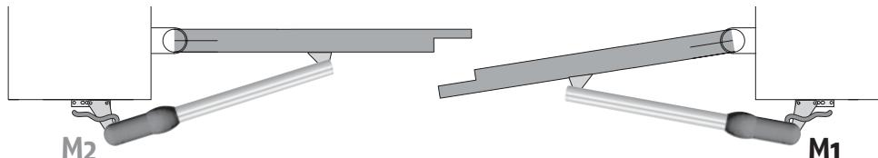
(F) Le vérin M1 est installé sur le pilier du vantail qui s'ouvre en premier et se referme en dernier.
