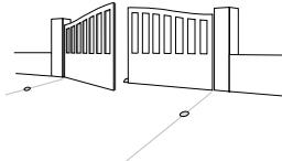
F Les vantaux doivent être arrêtés par des butées fixées solidement au sol afin que leur course soit délimitée à l'ouverture comme à la fermeture. L'emplacement de ces butées sera déterminé par l'angle d'ouverture des vantaux (< ou = à 120°). L'angle d'ouverture des deux vantaux peut être différent.
