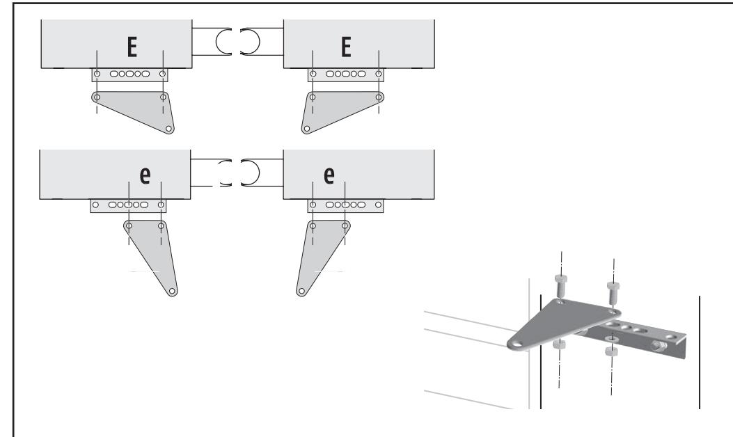
(F) Fixer la plaque de fixation vérin sur l'équerre en fonction du sens de montage «e» ou «E» déterminé.
