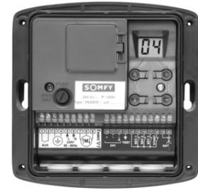
El receptor AXROLL permite gobernar a distancia una puerta de garaje enrollable equipada con un motor de 230 V con fines de carrera integrados, mediante transmisores Keytis 2/4 RTS, Telis1/4 RTS e Inis RT. Se puede conectar diferentes sistemas de seguridad y señalización en el AXROLL (barra palpadora, células fotoeléctricas, luces intermitentes, iluminación de zona).
