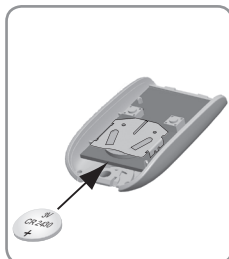
[4]. Substitua a pilha (3V CR 2430).
