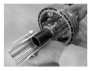
4.- Deslizar la segunda parte del anillo adaptador por debajo del tubo.
