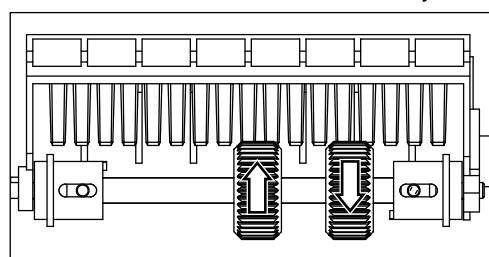
7- Pour affiner le réglage, appuyer sur le levier du minirupteur puis tourner les molettes dans le sens souhaité, cran par cran (1 cran ≈ 3 mm de course du tablier).
