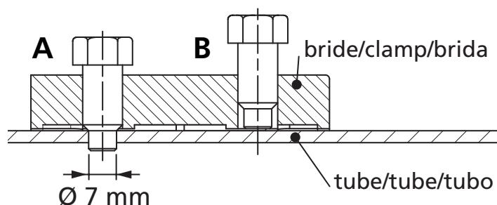
A : vissée dans le tube. - B : en pression sur le tube.
