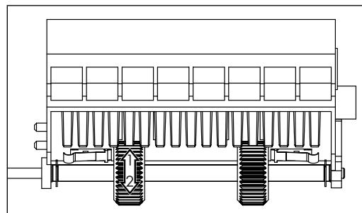
**5- Faire une montée et une descente pour vérifier les positions d'arrêt. Recommencer l'opération 4 si le réglage n'est pas satisfaisant (1 cran = 3 mm de course du tablier).**
