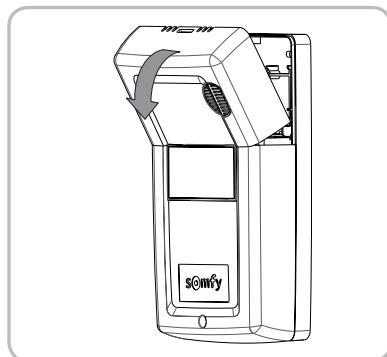
[2]. Desatornille y, a continuación, retire la tapa del receptor.
