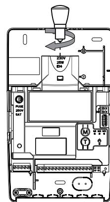
[3]. Sustituya y luego atornille la tapa del receptor.
