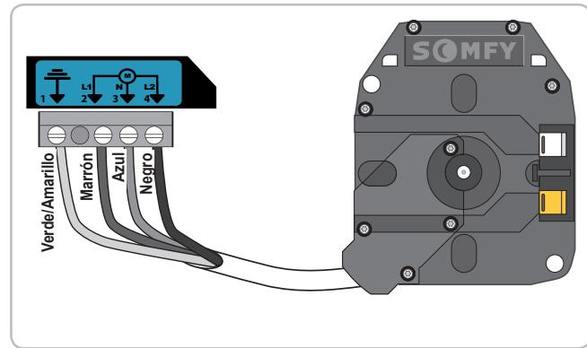
[2]. Bloquee el cable del motor con la abrazadera facilitada.
