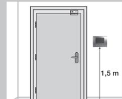
El teclado LCD debe estar fijado sobre una superficie plana y en ningún caso sobre un enlucido de espesor > 1,4 mm.
