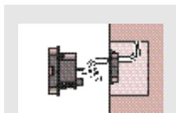
Realizar el cableado del receptor y fijar el receptor en el soporte.
