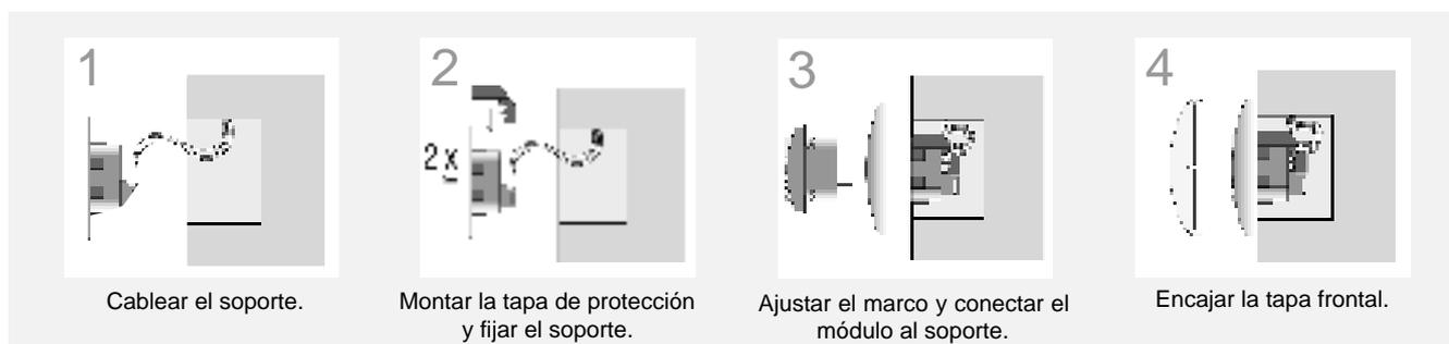
No olvidar montar la tapa de protección para separar los cables de la línea BUS y los cables de la alimentación.
