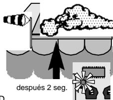
Mientras la velocidad del viento sea mayor que el nivel programado, el LED rojo permanece encendido y no se tiene en cuenta ninguna orden (manuales o automáticas). Cuando la velocidad del viento baja del nivel programado, el LED rojo parpadea.
