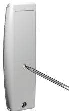
El LED del Soliris receptor RTS 2 parpadea, indicando que la dirección del emisor RTS está memorizada en el receptor, que abandona automáticamente su modo programación.
