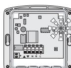
El LED del Soliris receptor RTS 2 parpadea, indicando que la dirección del INIS RT está memorizada en el receptor, que abandona automáticamente su modo programación.
