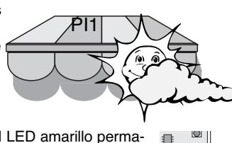
Cuando la intensidad de la luz baja del nivel programado, se activa un tiempo de espera, entre 15 y 30 minutos (según la duración de la presencia del sol), y el LED amarillo parpadea.
