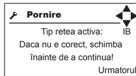
**IMPORTANT:** Dacă schimbați modul de rețea, trebuie să întrerupeți și apoi să reconectați alimentarea la controller.
