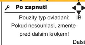
**UPOZORNĚNÍ:** Pokud změníte typ ovládání, je nutné centrální jednotku vypnout a znovu zapnout.
