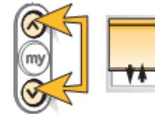
Pulsar subida o bajada para desplazar la enrollable hasta la posición deseada y pulsar My hasta que el motor haga Clack-Clack
