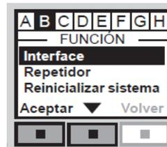
→ Aparece la pantalla indicando que se ajuste el canal. Se selecciona canal 7
