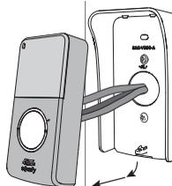
[3]. Marque todos os fios ligados à parte traseira da placa de rua (2 fios do monitor interior, 2 fios do trinco/fechadura eléctrica, 2 fios da motorização do portão).
