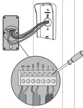
**[5].** Conecte los hilos del monitor a los dos terminales situados a la izquierda en la parte posterior de la nueva placa de calle:
