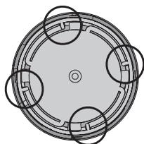
[7]. Monte a placa de fundo: alinhe as marcas da placa de fundo e do anel e rode a placa de fundo para a direita (utilizando os espigões da placa) até ao batente.
