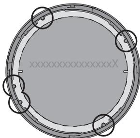
[5]. Coloque o vidro no anel. Atenção: na versão 1 botão, há um espigão de posicionamento que permite montar o vidro apenas numa posição.
