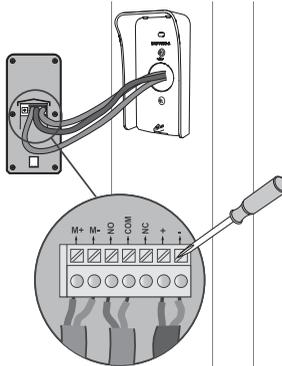
**[5].** Ligue os fios do monitor aos 2 bornes da esquerda, na face traseira da nova placa de rua:
