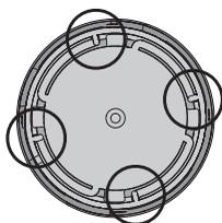
[7]. Vuelva a montar la placa de fondo: Alinee la marca de la placa de fondo y del anillo y gire la placa de fondo en el sentido horario (utilizando las pestañas de la placa) hasta el tope.
