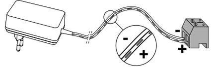
[3]. Conecte el conector del adaptador de corriente a la parte trasera del monitor en la regleta de bornes 5-1 en el sentido indicado en la ilustración (tornillos hacia la izquierda); el sentido de conexión de los cables de la fuente de alimentación es importante.
