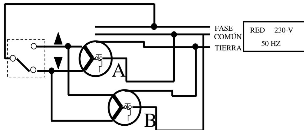
CUANDO LOS MOTORES “A” Y “B” SE CONECTAN A UN INVERSOR Y SE DA UNA MANIOBRA, LOS MOTORES GIRAN SIMULTANEAMENTE EN LA MISMA DIRECCIÓN
