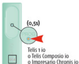
Pulsar la tecla "prog" de un mando con retorno de info El mando reconoce el repetidor
