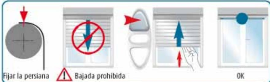
El ajuste de la posición baja se realiza automáticamente tras el ajuste de la posición alta.
