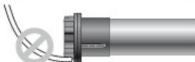
En caso de montaje en el exterior, es importante que el cable de alimentación esté arqueado para evitar la penetración del agua. Debe preverse una protección adicional para los casos de grandes proyecciones agua.
