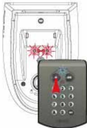
Mantener presionada la tecla del teclado a grabar colocando ese teclado sobre la marca hasta que los indicadores luminosos PROG de motor/Axovia estén intermitentes.
