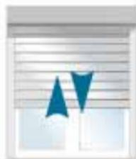
Para la puesta a cero de un motor ILMO, conectar juntos los cables "bajada y subida" en la fase hasta que la persiana rodante efectúe un primer y un segundo vaivén.
