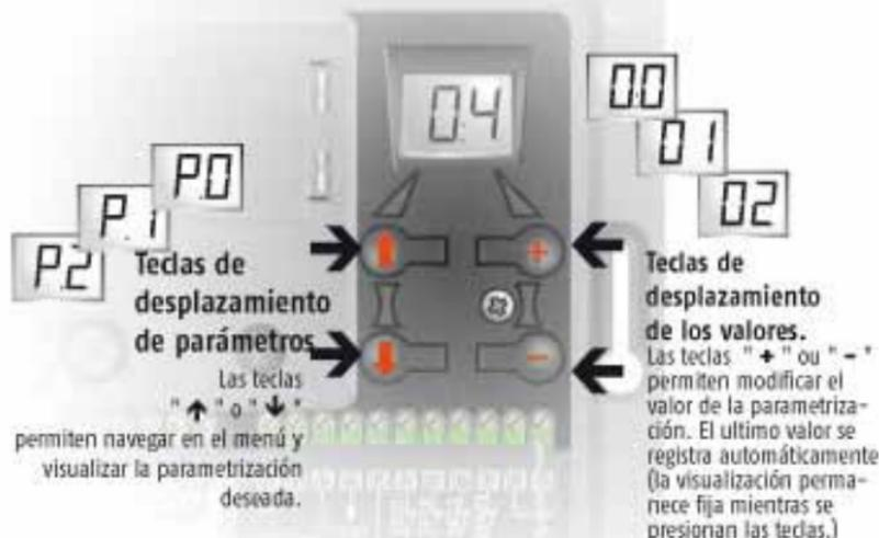
**!** Para volver al menú presionar las teclas "↑" o "↓" hasta volver al valor C1 (u otro valor que indique el estado de funcionamiento del producto) o tras 1 minuto de espera.
